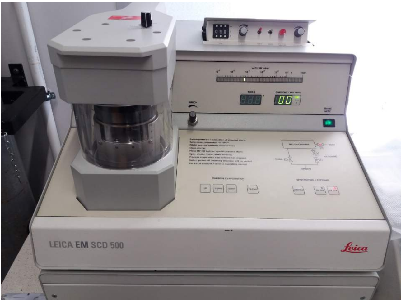
Fig 1: Przykład urządzenia do nanoszenia cienkich warstw metodą napylania.
