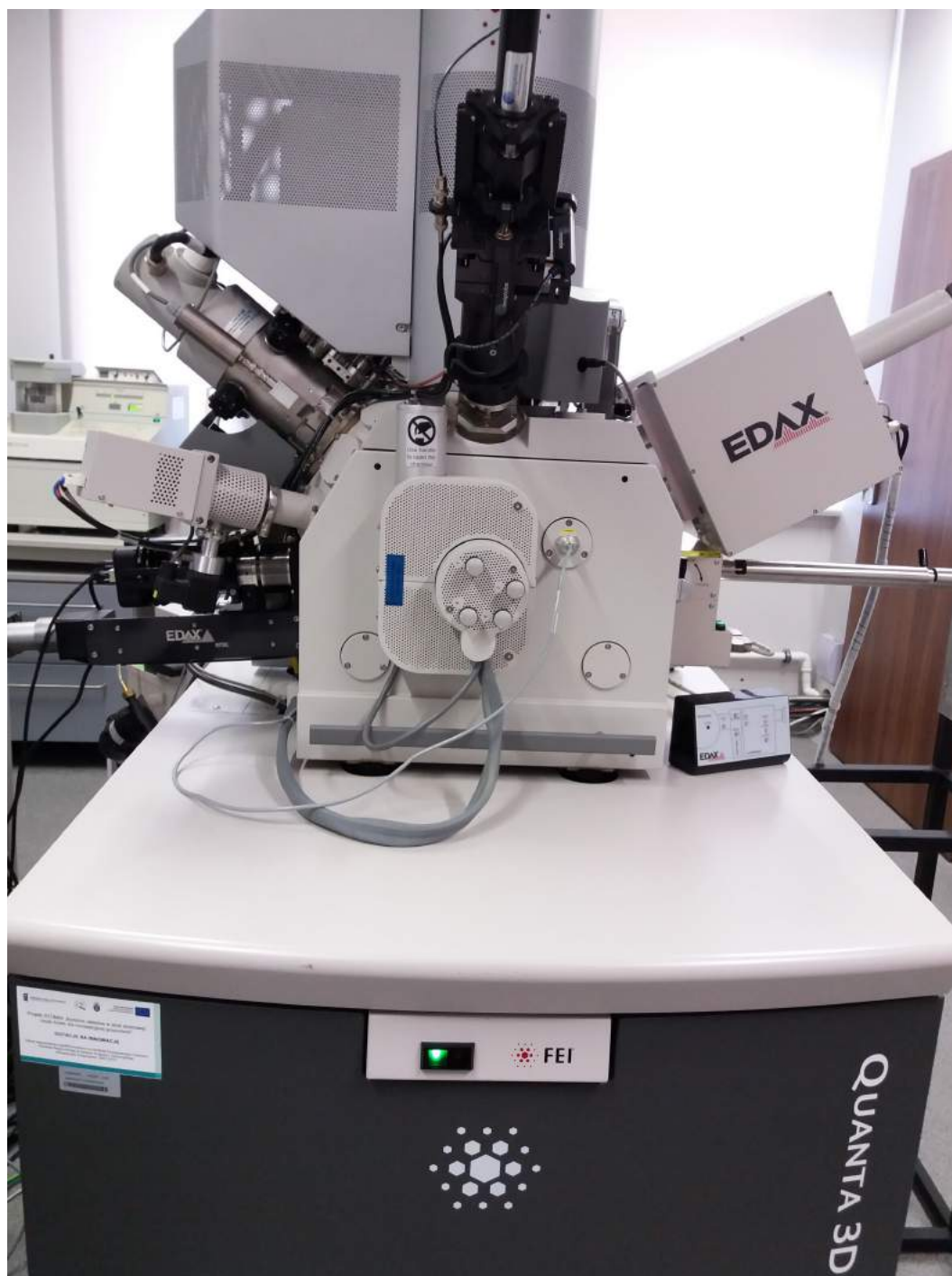
Fig 3: Skaningowy mikroskop elektronowy Quanta 3D FEG zainstalowany w Zakładzie Fizyki Ciała Stałego IF UJ. Mikroskop posiada spektrometr EDX.
